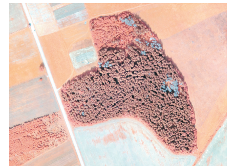
Lähis-infrapunakaameraga tehtud aerofoto, millelt eristuvad kuivanud puud. ALPHAGIS OÜ
